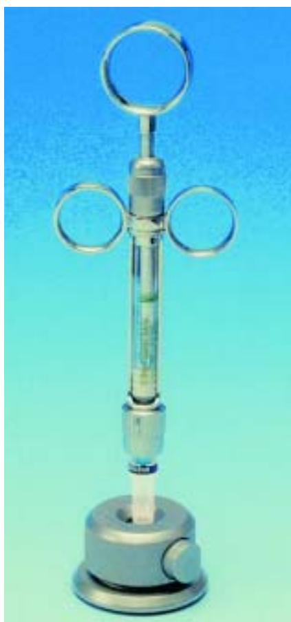
Abb. 3: Die Schutzhülse befindet sich fest im schweren Metallständer. Die mit der Spritze verbundene Kanüle steckt in der Schutzhülse. Der Ständer ist schwer genug, um die aufrecht stehende Spritze zu halten. Einzelheiten im Text.
