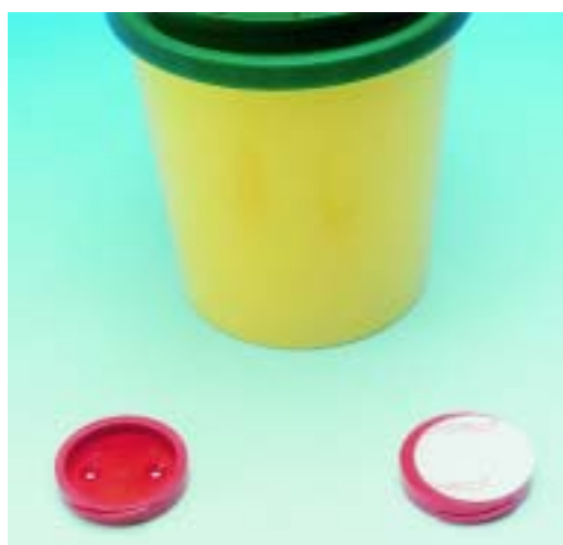
Abb. 5: Sammelgefäß, davor Gewindeplatten, die auf die Grundplatte geschraubt (links) oder geklebt (rechts) werden. Das Gefäß wird durch kurzes Eindrehen befestigt und zur Entsorgung durch Drehen gelöst.
